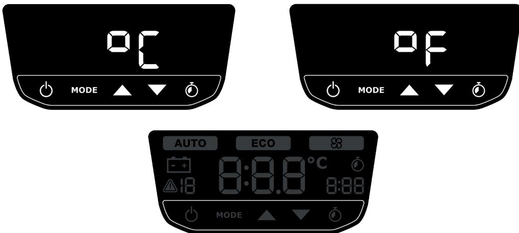
Wenn Sie die Geräteleistung erneut konfigurieren möchten, drücken Sie einfach bei ausgeschaltetem Gerät gleichzeitig die Tasten MODE und UHR des Bedienfelds, um die Konfiguration wieder aufzurufen. Um den Batterietyp, an den das Gerät angeschlossen ist, oder die Temperaturmaßeinheit erneut zu wählen, muss das Gerät zurückgesetzt werden, indem es vollständig von der Stromversorgung getrennt wird.
