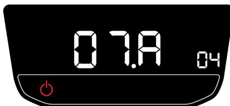
Transcurridos unos segundos, entrará en el modo de configuración inicial permitiendo seleccionar desde el panel de control la potencia máxima del equipo entre 1.2 (1.230 W) o 2.0 (2.020 W). Seleccione la opción deseada con los botones de incremento o reducción del panel o del mando a distancia y confirme esta opción pulsando el botón ON/OFF de Encendido / Apagado de la unidad.
