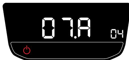
Dopo alcuni secondi, si entra nella modalità di configurazione iniziale e dal pannello di controllo è possibile impostare la potenza massima dell'apparecchiatura tra 1.2 (1.230 W) e 2.0 (2.020 W). Selezionare l'opzione desiderata con i tasti di aumento o diminuzione sul pannello o sul telecomando e confermare premendo il tasto ON/OFF dell'unità.
