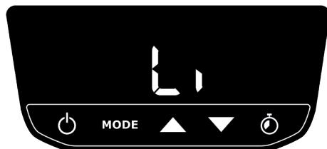
Per completare la configurazione, l'utente deve selezionare l'unità di misura in cui l'impianto rileva la temperatura, scegliendo tra gradi Celsius ( $^{\circ}\text{C}$ ) o gradi Fahrenheit ( $^{\circ}\text{F}$ ). Selezionare l'opzione desiderata con i tasti di aumento o diminuzione del pannello di controllo o sul telecomando e
