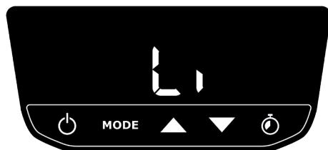
Um die Konfiguration abzuschließen, muss der Benutzer die Maßeinheit für die Temperaturmessung des Geräts wählen (Grad Celsius (°C) oder Grad Fahrenheit (°F)). Wählen Sie die gewünschte Option mit den Auf- und Ab-Pfeiltasten von Bedienfeld oder Fernbedienung und bestätigen Sie Ihre Wahl.
