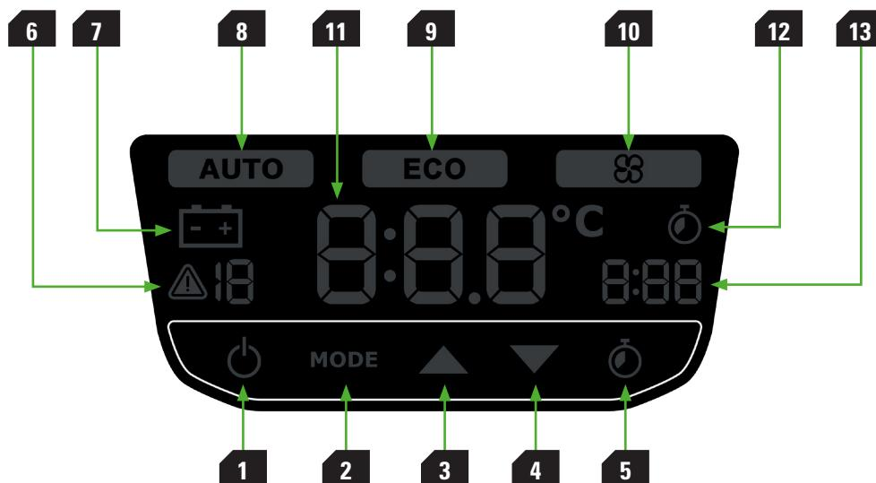
**1 ON/OFF:** Botón de Encendido / Apagado de la unidad. Al presionar una vez, la unidad se enciende y queda lista para su funcionamiento. Al pulsar de nuevo, se apaga la unidad.
