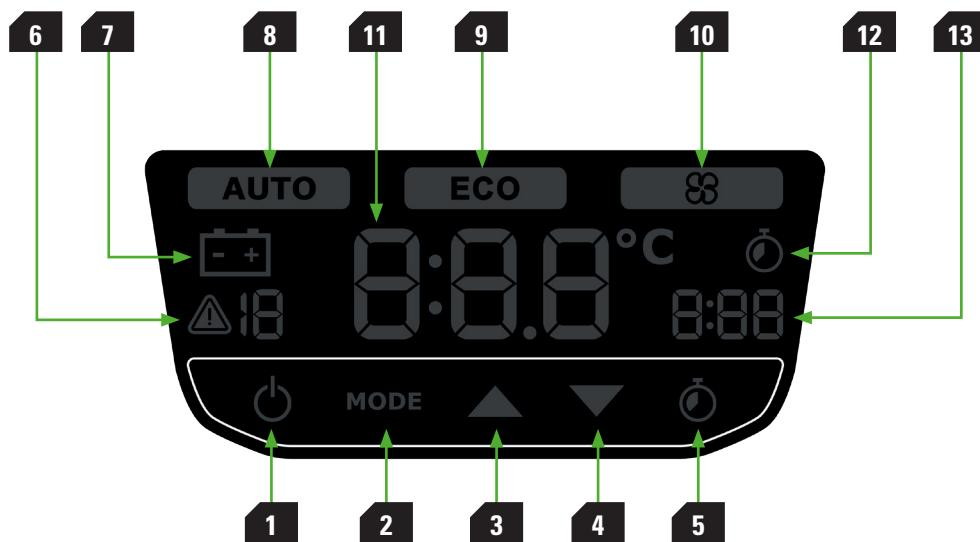
**1 ON/OFF:** Tasto di accensione/spegnimento dell'unità. Quando viene premuto una volta, l'unità si accende ed è pronta per il funzionamento. Premendolo di nuovo, l'unità si spegne.
