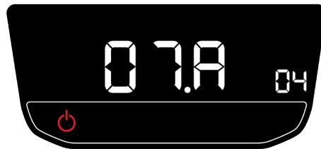
Nach einigen Sekunden geht das Gerät in den Konfigurationsmodus über und Sie können auf dem Bedienfeld die maximale Leistung des Geräts zwischen 1.2 (1230 W) und 2.0 (2020 W) wählen. Wählen Sie die gewünschte Option mit den Auf- und Ab-Pfeiltasten von Bedienfeld oder Fernbedienung und bestätigen Sie Ihre Wahl durch Drücken der Ein-/Aus-Taste am Gerät.
