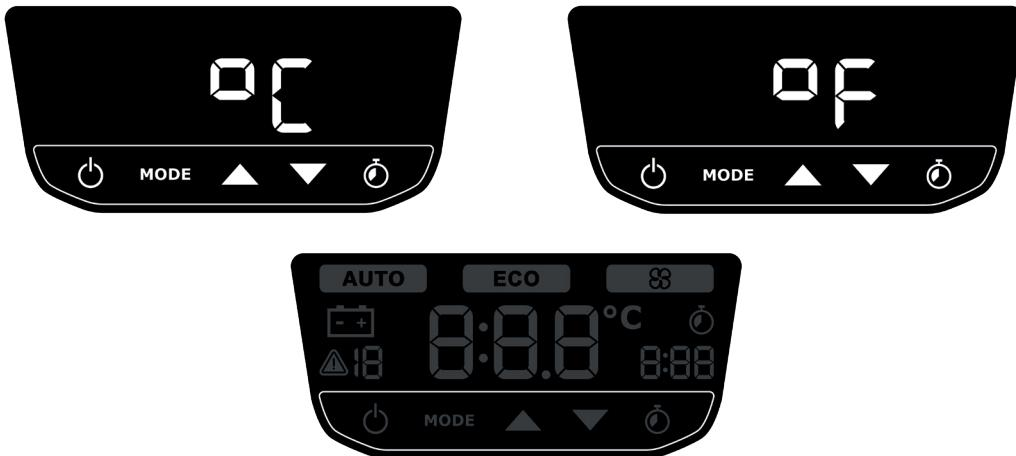
Si vous souhaitez reconfigurer l'alimentation de l'appareil, il suffit d'appuyer simultanément sur les boutons MODE et HORLOGE du panneau de commande, l'appareil étant éteint, pour accéder à nouveau à la configuration. Pour sélectionner à nouveau le type de batterie auquel l'appareil est connecté ou la plage de mesure de la température, l'appareil doit être réinitialisé en le déconnectant complètement de l'alimentation électrique.
