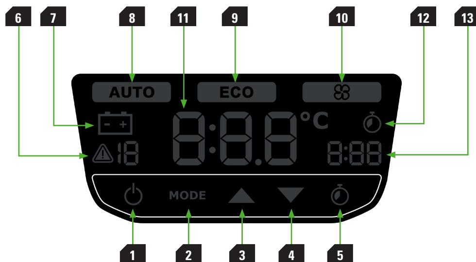
**1 EIN/AUS:** Ein-/Aus-Taste des Geräts. Bei einmaligem Drücken schaltet sich das Gerät ein und ist betriebsbereit. Durch erneutes Drücken wird das Gerät ausgeschaltet.
