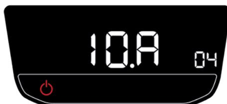
Transcurridos unos segundos, entrará en el modo de configuración inicial permitiendo seleccionar desde el panel de control el tipo de batería del que dispone el vehículo y a la que está conectada la unidad, seleccionando entre batería de plomo (Pb) o batería de litio (Li). Seleccione la opción deseada con los botones de incremento o reducción del panel de control o del mando a distancia y confirme esta opción con el botón ON/OFF de Encendido / Apagado del enfriador.
