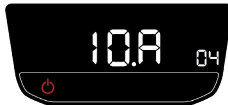
Après quelques secondes, il entre en mode de configuration initiale, ce qui permet de sélectionner sur le panneau de commande le type de batterie dont dispose le véhicule et à laquelle l'unité est connectée, en choisissant entre une batterie au plomb (Pb) ou une batterie au lithium (Li). Sélectionnez l'option souhaitée à l'aide des boutons d'augmentation ou de diminution du panneau de commande ou de la télécommande et confirmez cette option à l'aide du bouton ON/OFF du refroidisseur.
