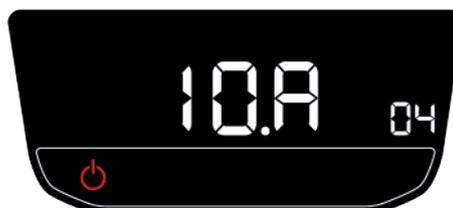
Nach einigen Sekunden geht das Gerät in den anfänglichen Konfigurationsmodus über, in dem Sie über das Bedienfeld den Fahrzeugbatterietyp (Bleisäure- (Pb) oder Lithiumbatterie (Li)) auswählen können, an den das Gerät angeschlossen ist. Wählen Sie die gewünschte Option mit den Auf- und Ab-Pfeiltasten von Bedienfeld oder Fernbedienung und bestätigen Sie Ihre Wahl durch Drücken der Ein-/Aus-Taste am Kühlgerät.
