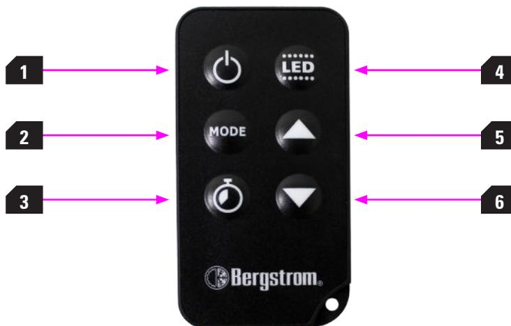
**1** **ON/OFF:** tasto di accensione/spegnimento dell'unità. Quando viene premuto una volta, l'unità si accende ed è pronta per il funzionamento. Quando si preme con il raffrescatore acceso, l'unità si spegne.
