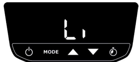
Per completare la configurazione, l'utente deve selezionare l'unità di misura in cui il raffrescatore rileva la temperatura, scegliendo tra gradi Celsius (°C) o gradi Fahrenheit (°F). Selezionare l'opzione desiderata con i tasti di aumento o diminuzione del pannello di controllo o sul telecomando e confermare con il tasto ON/OFF del raffrescatore. Dopo quest'ultima conferma, l'unità va in "Standby" ed è pronta per l'accensione.
