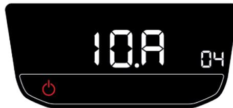
Dopo qualche secondo, si accede al modo di configurazione iniziale e dal pannello di controllo è possibile selezionare il tipo di batteria di cui è dotato il veicolo e a cui l'unità è collegata, scegliendo tra la batteria al piombo (Pb) o al litio (Li). Selezionare l'opzione desiderata con i tasti di aumento o diminuzione del pannello di controllo o sul telecomando e confermare con il tasto ON/OFF del raffrescatore.
