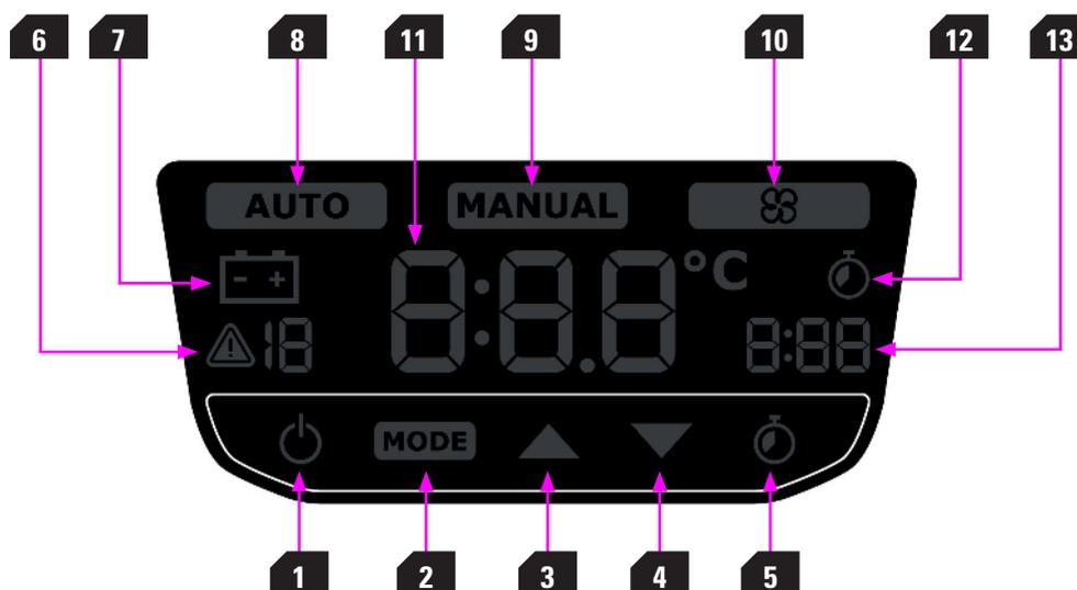
**1 ON/OFF:** tasto di accensione/spengimento del raffrescatore. Quando viene premuto una volta, l'unità si accende ed è pronta per il funzionamento. Quando si preme con il raffrescatore acceso, l'unità si spegne.
